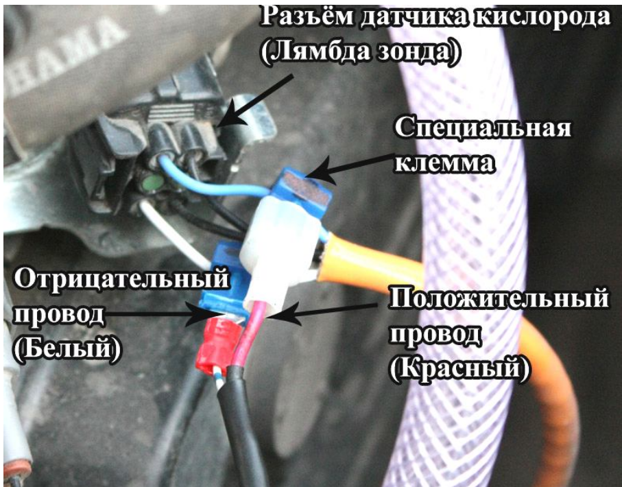
Рисунок 3.1. Схема подключения циркониевого датчика кислорода.
